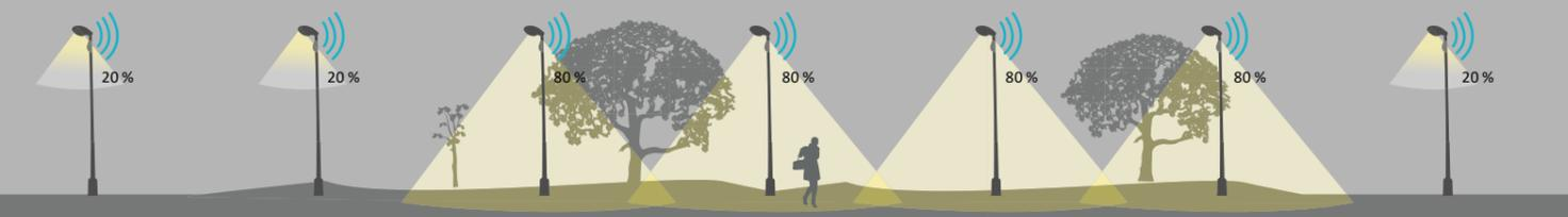
Der Sensor erfasst den Fußgänger (ab 2 km/h) und kommuniziert mit den benachbarten Lichtmasten über: Höhe des Lichtlevels, Anzahl und Dauer der aktivierten Leuchten.
