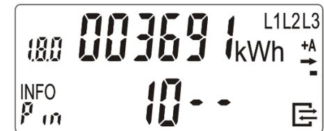
Zur Eingabe der PIN leuchten Sie auf die optische Taste. Nach dem Displaytest (Anzeigeelemente in erster und zweiter Zeile werden wechselhaft eingeleuchtet) erfolgt die PIN-Abfrage.
